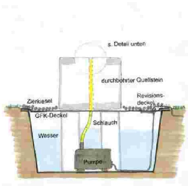
Die Pumpe wird hineingestellt und der Schlauch angeschlossen. Danach wird der GFK-Deckel aufgelegt und der Sprudelstein an seine Position gerückt. Nun wird der Schlauch von unten in den Quellstein gesteckt, bis er sich etwa 1 cm unterhalb der oberen Öffnung befindet. Der Zwischenraum zwischen Schlauch und Stein wird mit Silikon o. ä. abgedichtet.
