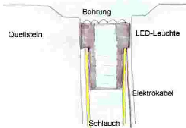
Zusätzlich kann zur Beleuchtung eine LED-Leuchte mit in die Bohrung gesetzt werden. Hierzu wird der Schlauch auf die LED-Leuchte gezogen und alles zusammen mit dem Elektrokabel der LED-Leuchte durch die Bohrung gezogen.
