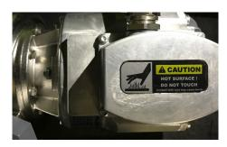
Vorsicht: Die Oberfläche der Pumpe kann sehr heiß sein (bis zu 75 °C). Berühren Sie die Oberfläche nicht direkt, bevor Sie diese überprüft haben. Für die Pumpe selbst ist diese Temperatur normal und kein Problem. Sorgen Sie immer für eine gute Belüftung der Pumpe.
