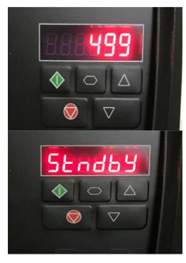
Wenn die Steuereinheit mit dem Stromnetz verbunden wird, bringt sie die Pumpe testhalber auf eine Drehzahl von 499 und anschließend wieder auf 0.
