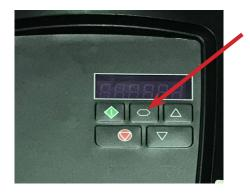
Drehzahl in U/min A – nicht relevant P – Leistung in kW U – nicht relevant
