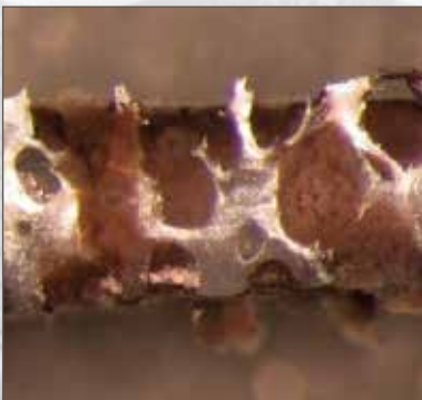
Bild 3: Querschnitt durch das Porensystem mit aktiver Biomasse, Scheibendicke ca. 1,1 mm
