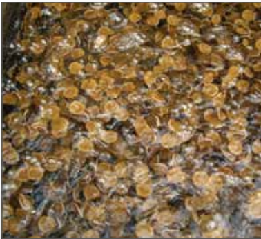
Bild 5: Nitrifikation mittels BioActiv-Pad (ehemals helle Variante) im RAS Prozess einer Fischzuchtanlage
